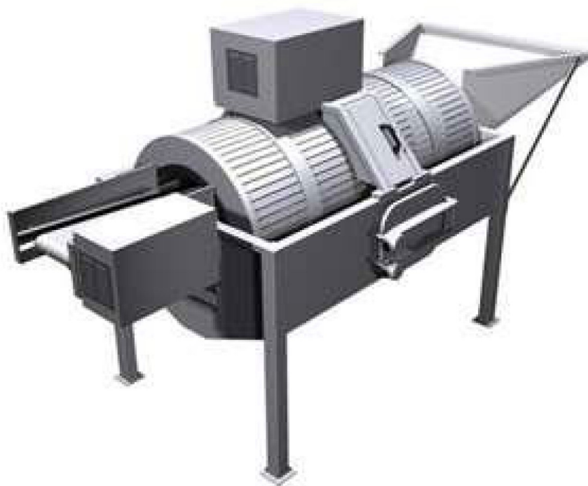
Rys. 20. Myjka bębnowa o poziomej osi obrotu (za zgodą MIR-PIB)
