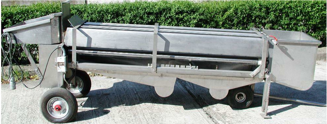
Rys. 21. Zaprojektowana w MIR sortownica rolkowo-szczelinowa (fot. za zgodą MIR-PIB)
