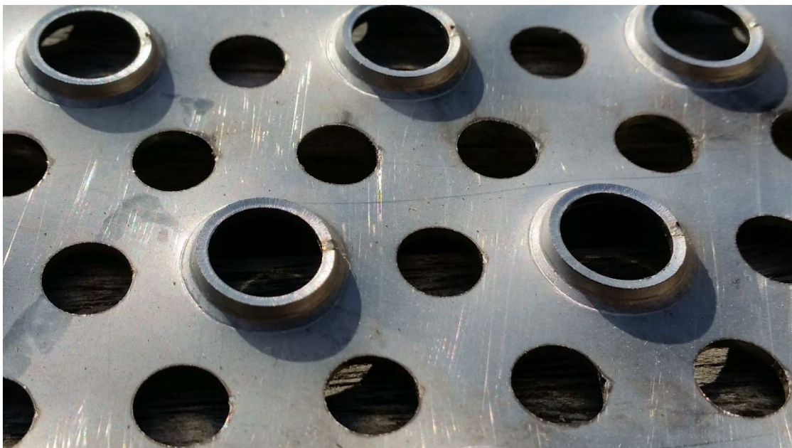
Rys. 12. Perforacja stosowana przy łatwo odłuszczających się rybach (za zgodą ZM Czerwiński)
