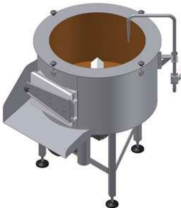
Rys. 15. Odłuszczarka bębnowa o pionowej osi obrotu (opracowanie MIR-PIB)
