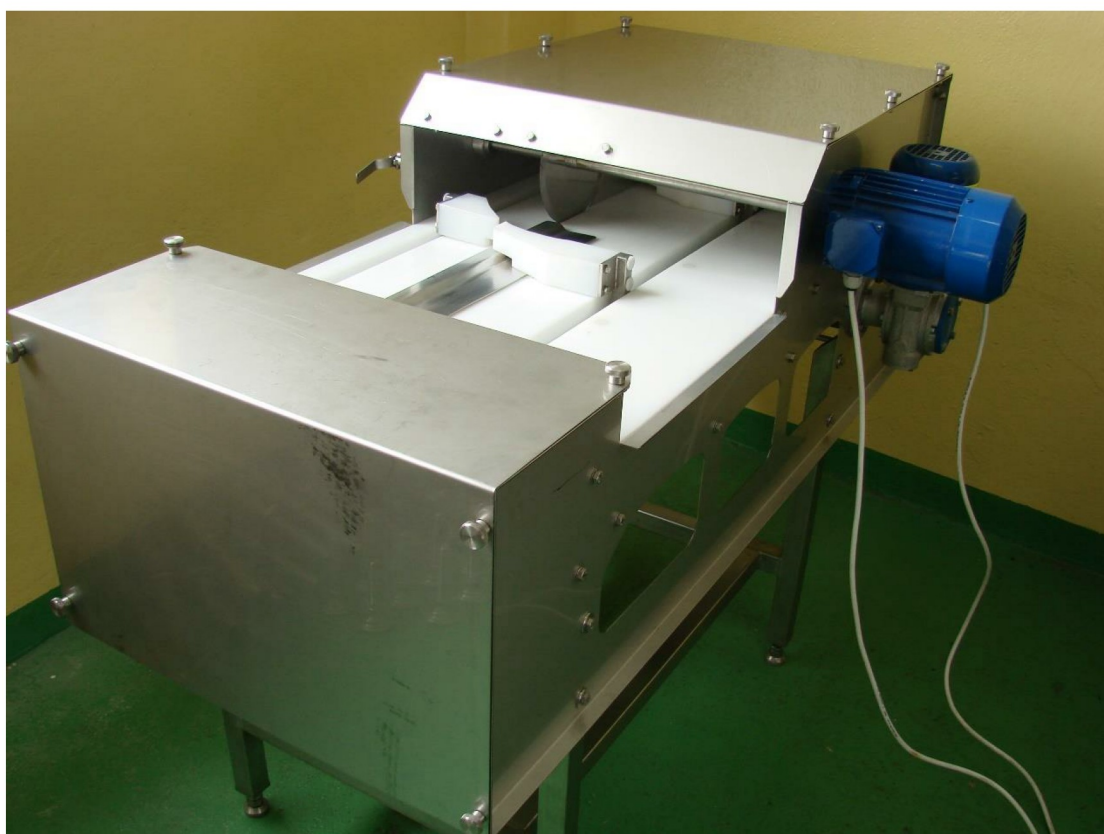
Rys. 26. Odgławiarz z cięciem prostym (fot. za zgodą MIR-PIB)
