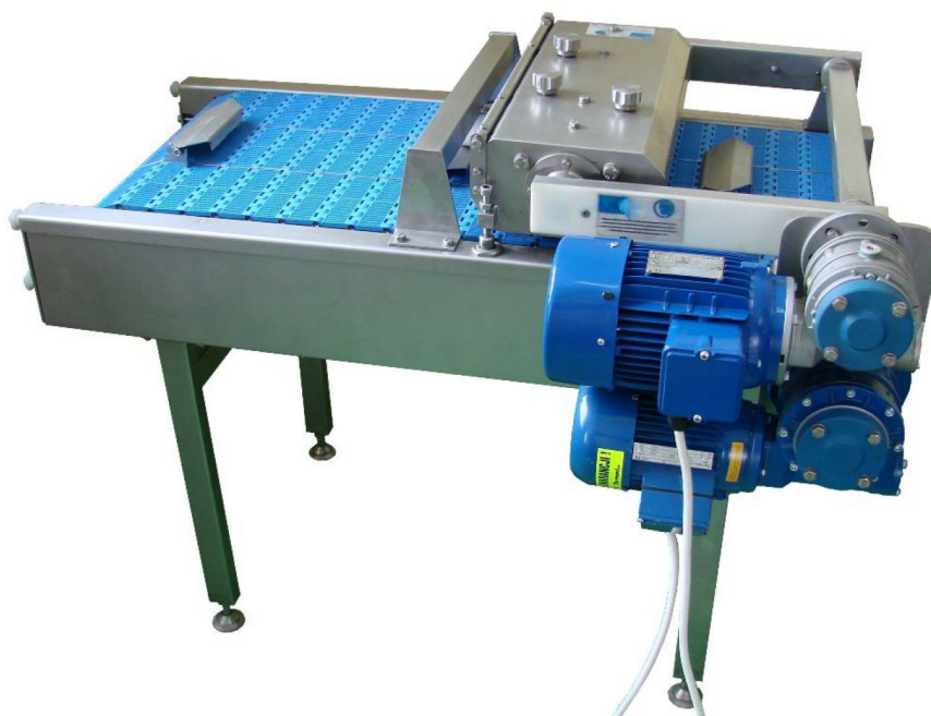
Rys. 60. Prototyp urządzenia do przecinania ości w płatach (fot. za zgodą MIR-PIB)
