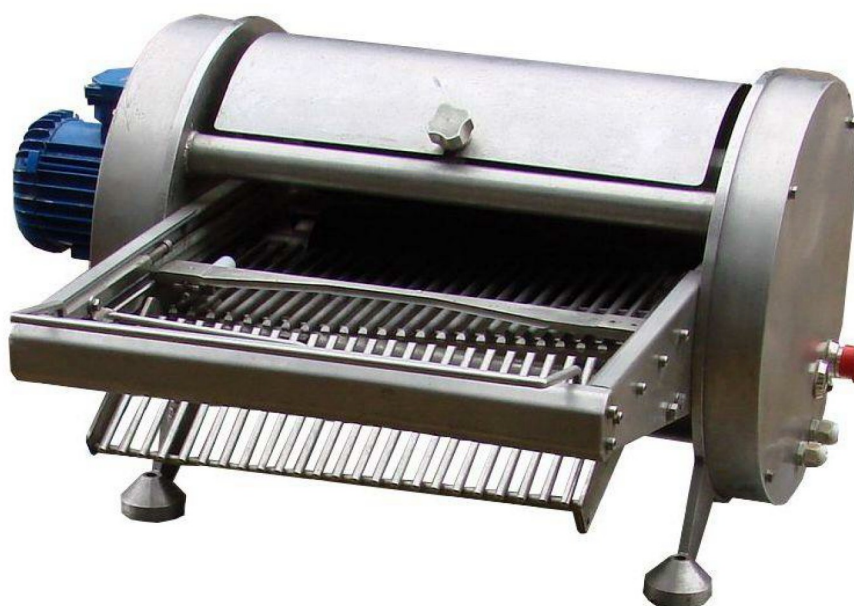
Rys. 57. Prototyp urządzenia do przecinania ości w tuskach (fot. za zgodą MIR-PIB)
