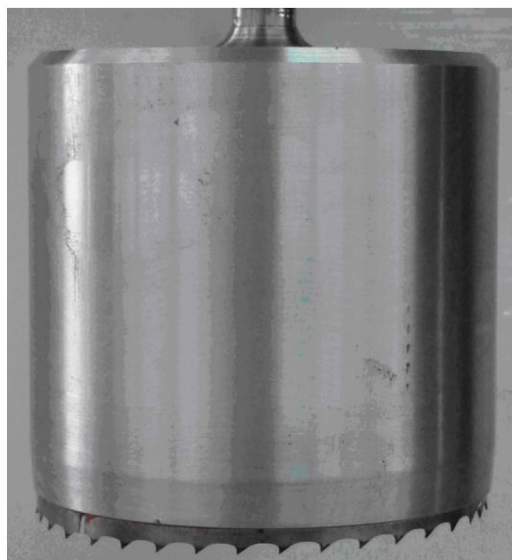
Rys. 30. Rys. 3.19. Nóż cylindryczny do odgławiania cięciem okołoskrzelowym po łuku (fot. za zgodą MIR-PIB)
