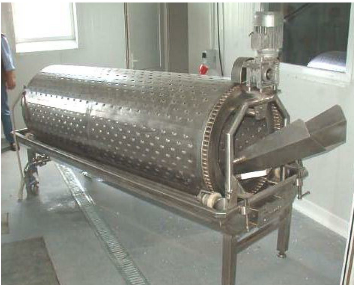
Rys. 17. Odłuszczarka bębnowa o poziomej osi obrotu produkcji ZM Czerwiński
