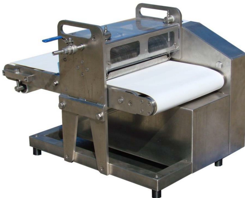
Rys. 61. Przenośnikowa przecinarka ości w filetach karpi i ryb karpiowatych (fot. za zgodą MIR-PIB)
