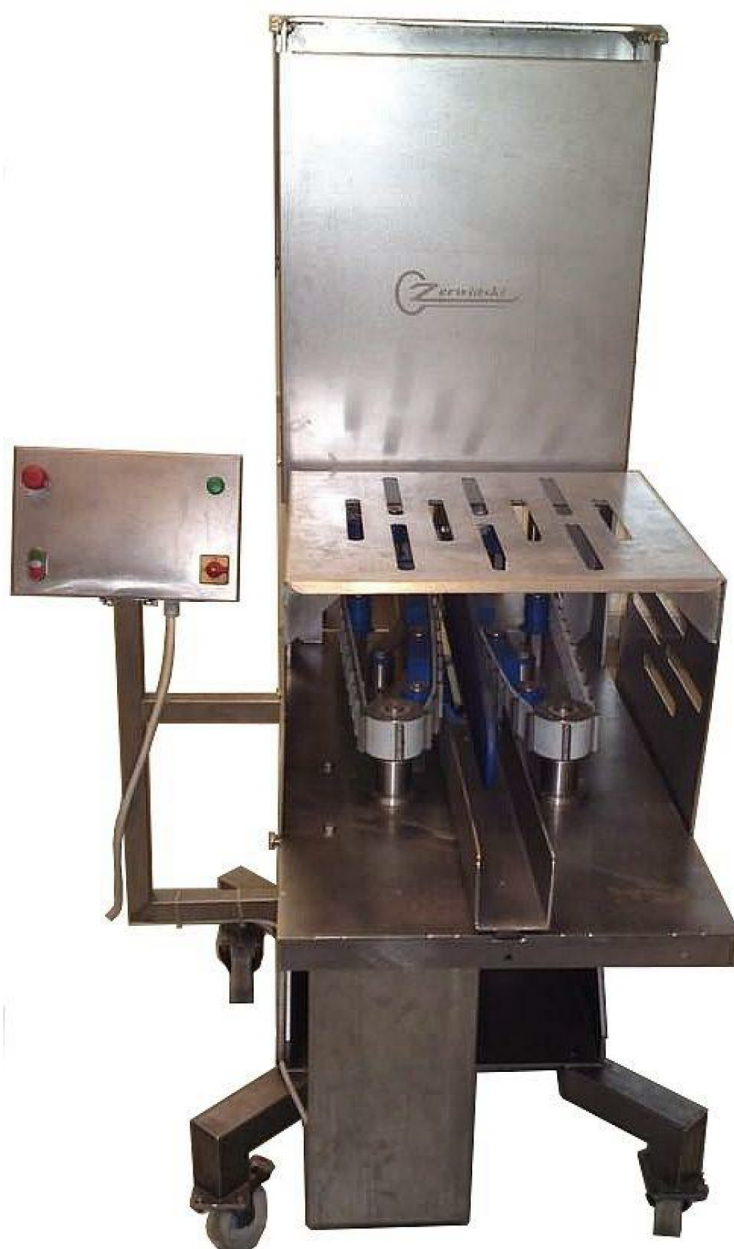
Rys. 45. Płatownica z nożami taśmowymi produkcji ZM Czerwiński ( za zgodą ZM Czerwiński)
