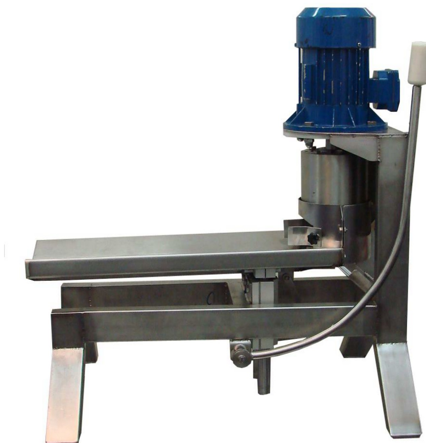
Rys. 32. Prototyp urządzenia do odgławiania cięciem okołoskrzelowym po łuku (fot. za zgodą MIR-PIB)
