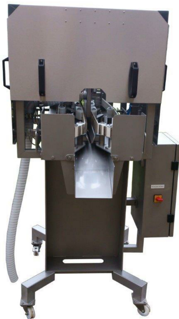
Rys. 37. Patroszarka do karpia produkcji ZM Czerwiński (za zgodą ZM Czerwiński)
