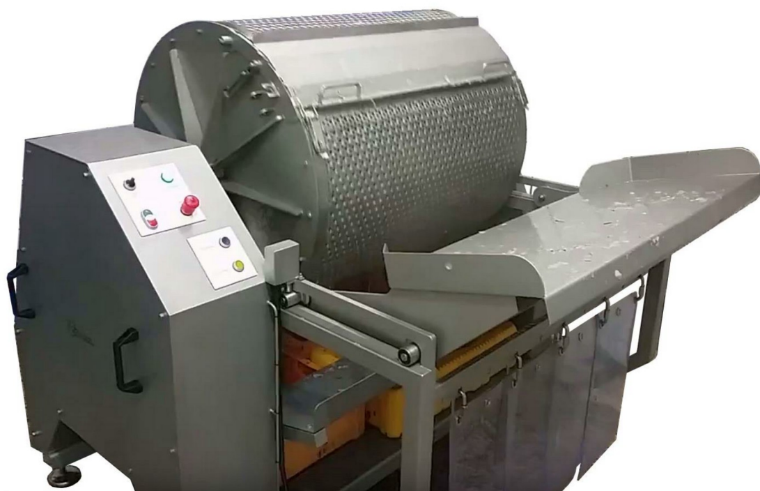
Rys. 14. Odłuszczarka bębnowa pozioma produkcji ZM Czerwiński
