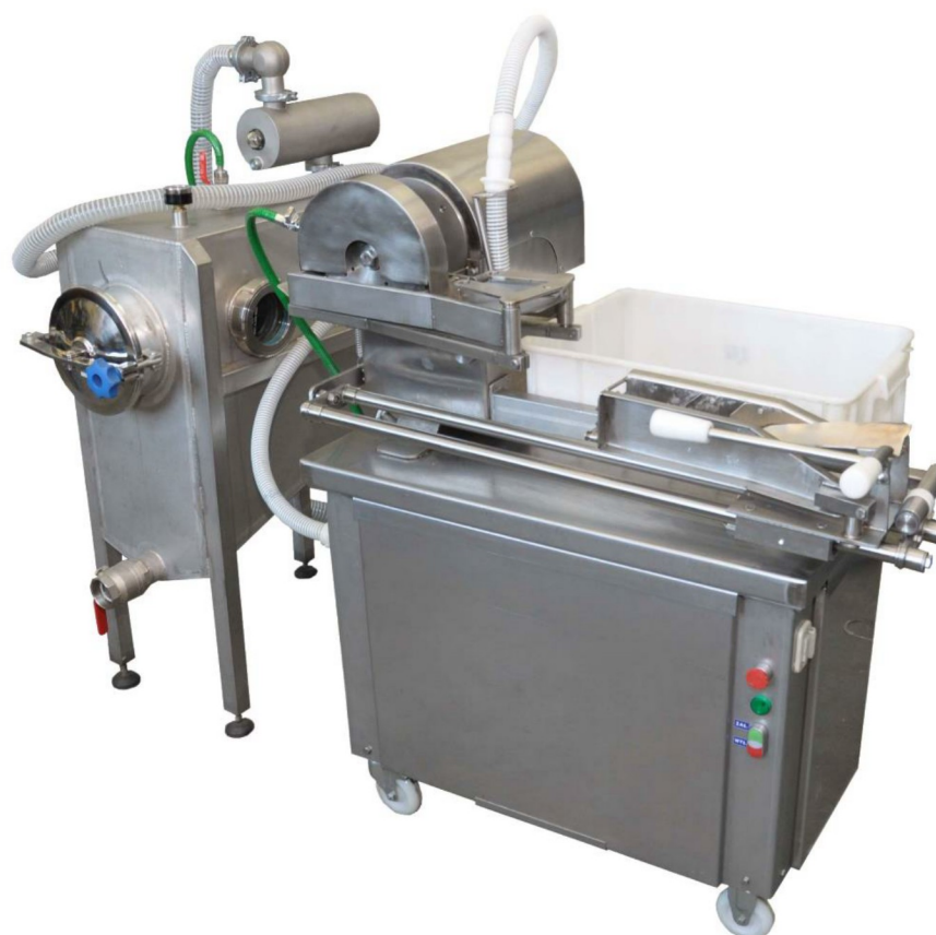
Rys. 39. Patroszarka podciśnieniowa (opracowanie własne)
