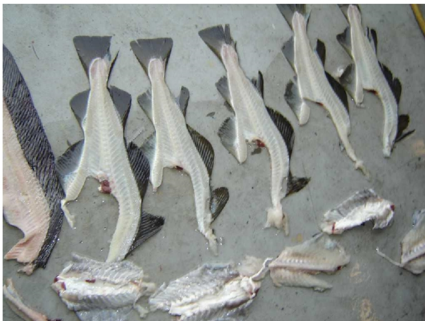
Rys. 5. Kręgosłupy po obróbce w urządzeniu Frame Cutter – 10 FFC01 (na podstawie materiałów informacyjnych firmy Skaginn 3x)
