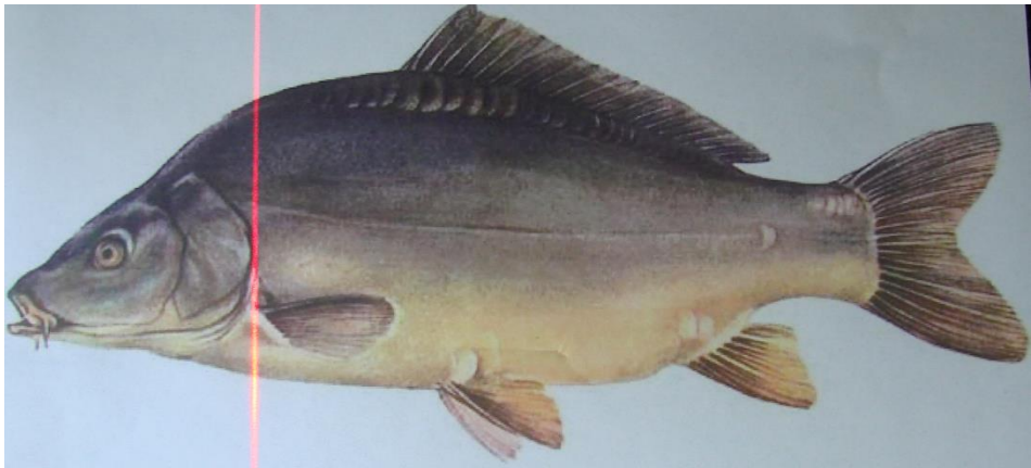
Rys. 4.19. Linia laserowa ułatwiająca orientację położenia ryby podczas odgławiania (fot. za zgodą MIR-PIB)
