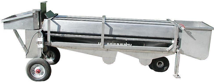
Rys. 4.11. Zaprojektowana w MIR sortownica rolkowo-szczelinowa (fot. za zgodą MIR-PIB)
