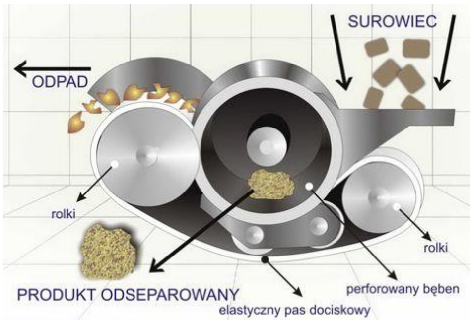
Rys. 4.71. Schemat budowy i działania separatora bębnowego (opracowanie własne na podstawie https://www.sepamatic.de/en/products#&gid=lightbox-group-78&pid=0 )
