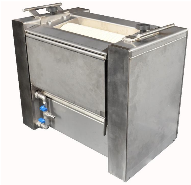
Rys. 4.60. Opracowana w MIR-PIB stołowa przecinarka świeżych i mrożonych filetów na paski (fot. za zgodą MIR-PIB)
