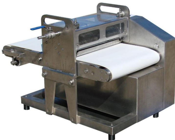
Rys. 4.50. Przenośnikowa przecinarka ości w filetach karpia i ryb karpiowatych produkcji ZM Czerwiński (oferta firmy ZM Czerwiński)
