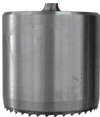
Rys. 4.17. Nóż cylindryczny do odgławiania cięciem okołoskrzelowym po łuku (fot. za zgodą PK i MIR-PIB)
