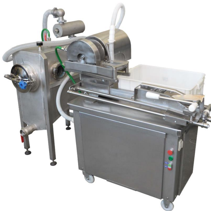
Rys. 4.28. Modułowa patroszarka podciśnieniowa (fot. za zgodą PK i MIR-PIB)
